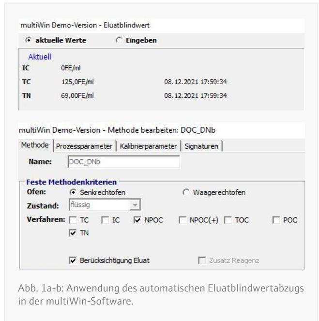
Abb. 1a-b: Anwendung des automatischen Eluatblindwertabzugs in der multiWin-Software.
